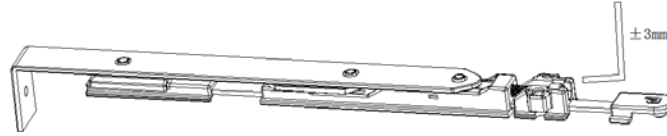
图 3 斜拉杆调节示意图
